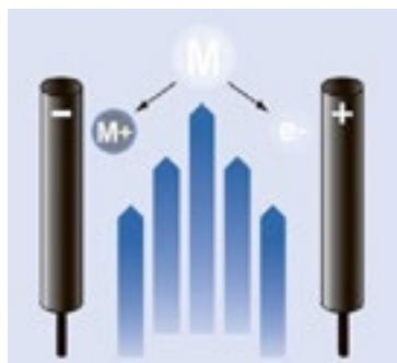
Многие органические вещества токсичны в концентрациях намного меньше нижнего предела взрываемости, по причине чего их сложно обнаружить термокаталитическими или инфракрасными сенсорами. Для таких случаев предназначены фотоионизационные сенсоры (англ. PID – photoionisation detector). Они определяют летучие органические соединения даже в минимальных концентрациях, что жизненно важно при работе в замкнутых пространствах, поиске утечек и т.д.
