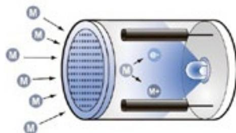
Как это работает? Когда воздух проходит через PID-сенсор, молекулы органических и неорганических веществ ионизируются под действием ультрафиолетового излучения специальной лампы. Свободные электроны и ионы создают ток, значение которого пропорционально содержанию в воздухе молекул анализируемого вещества. Ток преобразуется в электрический сигнал.
